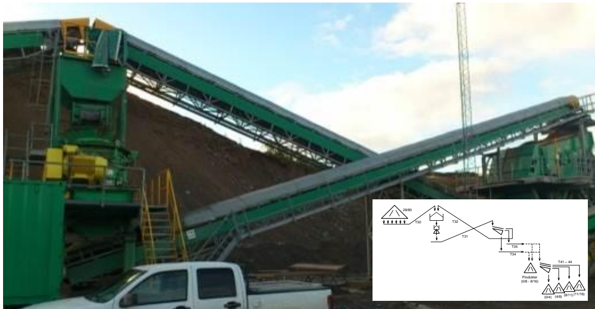
Figur 5. Del av processen i Riksten och flödesschemat för observerade steget på den infogade bilden till höger.
