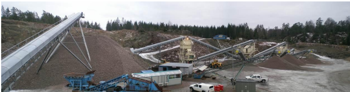
Figur 1. Tredjesteget i NCC:s anläggning Glimmingen utanför Uddevalla. I mitten ses krossen och till höger de två siktarna.
